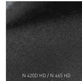
Dieses Nylon kommt überall dort zum Einsatz, wo es besonders um Widerstandsfähigkeit und möglichst hohe Abriebfestigkeit geht, bei trotzdem geringem Gewicht. Robust und hochwertig, wird es durch eine entsprechende Beschichtung auf der Innenseite auf Wasserfestigkeit veredelt.
